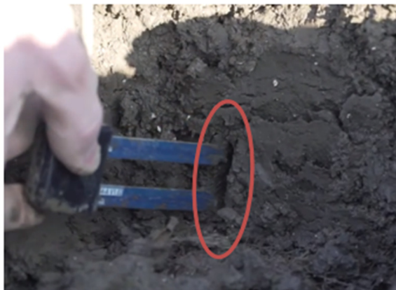
Figuur 2. Plaatsing bodemvocht- (links) en zuigspanningssensor (rechts) in voorgestoken gaten.
