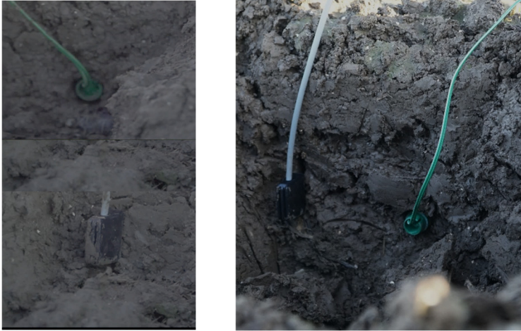
Figuur 3. Bodemvocht en zuigspanning sensor. Boven of naast elkaar
